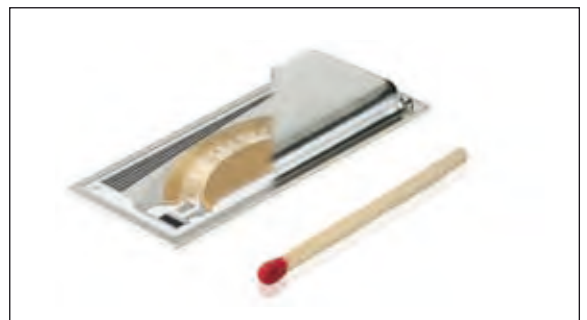
Das hermetisch gekapselte MAPPS-Element mit nur etwa vier Zentimetern Länge.
