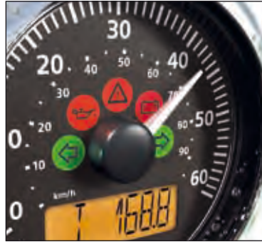
Gut sichtbare LED-Warnlampen
